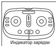
Во время зарядки светится синий индикатор зарядки. Когда батареи полностью зарядятся, синий индикатор погаснет.
