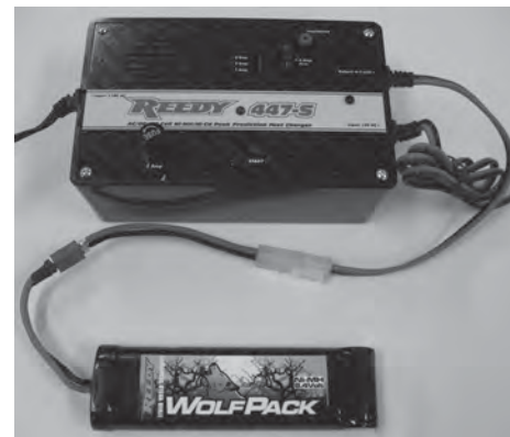
Зарядное устройство для быстрой зарядки с возможностью определения пика напряжения
