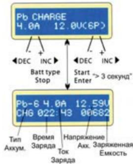
В левой части устанавливается ток заряда, в правой устанавливается номинальное напряжение аккумулятора. Ток заряда регулируется в пределах 0.1-5.0А Напряжение должно соответствовать спецификации аккумулятора.
