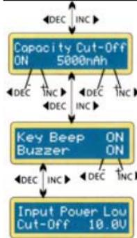
Эта функция обеспечивает защиту по максимальной емкости заряда. Если функция “дельта-пик” или таймер безопасности не отключили заряд, процесс заряда автоматически прекратится при достижении заданного лимита емкости.
