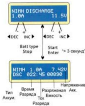
В левой части устанавливается ток разряда, в правой устанавливается напряжение до которого необходимо разрядить аккумулятор. Ток разряда регулируется в пределах 0.1-1.0А Напряжение разряда регулируется в пределах 0.1-25.0В
