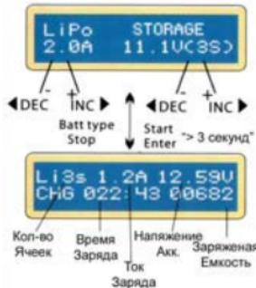
На этом дисплее пользователь устанавливает ток и напряжения для хранения аккумулятора. Функция заряда или разряда доведет напряжение аккумулятора до установленного "STORAGE" уровня.
