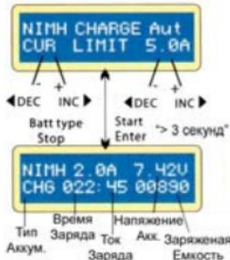
Эта программа используется для заряда NiCd/NiMH аккумуляторов применяемых в радиоуправляемых моделях. Для изменения значений необходимо нажать кнопку START/ENTER после чего значение параметра начнет мигать и его можно изменить кнопками “INC” и “DEC”. Для сохранения необходимо нажать кнопку START/ENTER еще раз.
