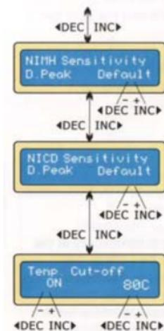
Этот параметр устанавливает значение “дельта-пик” при котором прекращается заряд NiCd и NiMH аккумуляторов. Рабочее значение 5-20мВ на ячейку. Если значение выше необходимого, то есть опасность перегрева аккумулятора. Если значение меньше необходимого, то возможно преждевременное отключение заряда. Следуйте указаниям инструкции к аккумулятору. (Заводские установки: NiCd: 12мВ, NiMH: 7мВ)
