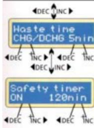
В процессе цикла заряда/разряда аккумулятор нагревается. Этот параметр устанавливает задержку по времени между каждым процессом заряд/разряд для того, чтобы аккумулятор успел остыть перед очередным циклом
