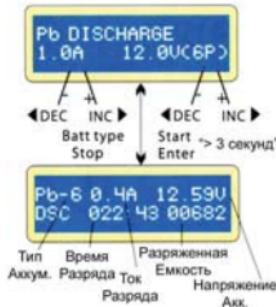
В левой части устанавливается ток разряда, в правой устанавливается номинальное напряжение аккумулятора. Ток разряда регулируется в пределах 0.1-1.0А Напряжение должно соответствовать спецификации аккумулятора.
