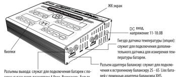
мощью разъемов диаметром 4,0мм. Внимание: Будьте осторожны! Строго соблюдайте полярность подключения
