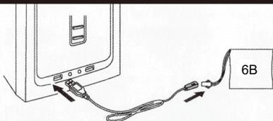
Соблюдая полярность, соедините разъем аккумулятора с соответствующим разъемом USB кабеля для зарядки, противоположный разъем USB кабеля вставьте в USB порт включенного компьютера или USB зарядника для телефона. Во время процесса зарядки будет светиться красный индикатор, когда индикатор погаснет, это значит, что аккумулятор полностью заряжен и его необходимо отключить от USB кабеля.
