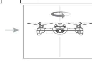
Наклоните модель носом вниз и поверните ее против часовой стрелки до того пока "Set Compass 2" исчезнет с экрана. После чего калибровка будет завершена.
