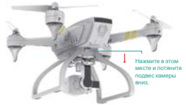
Демонтаж подвеса камеры
