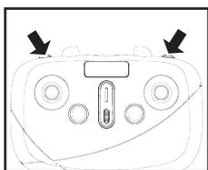
Способ 3: установите дрон на ровную горизонтальную поверхность и одновременно нажмите две кнопки на верхней панели пульта управления. Дрон взлетит в автоматическом режиме и зависнет на определенной высоте.
