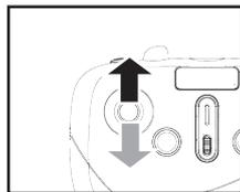
3. Переместите левую ручку пульта управления до упора вверх, а затем до упора вниз. Когда прозвучит длинный звуковой сигнал, это значит, что связь пульта с квадрокоптером установлена и определение носовой части в режиме «Headless» завершено.
