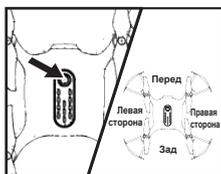
2. Включите питание дрона, нажав и удерживая 1-2 секунды кнопку выключения/включения питания на верхней части корпуса дрона. Затем установите квадрокоптер на ровную поверхность, точно расположив его хвостовой частью к пульта.
