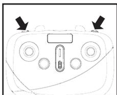
Способ 3: когда дрон находится в полете, одновременно нажмите две кнопки на верхней панели пульта управления, квадрокоптер плавно приземлится и моторы автоматически выключатся.
