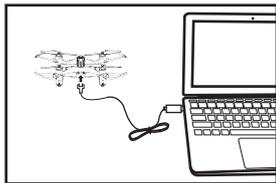
Вставьте соответствующий разъем USB кабеля для зарядки в гнездо для зарядки на корпусе дрона, а противоположный разъем USB кабеля для зарядки подключите в USB порт компьютера. (Во время зарядки будет светиться индикатор, расположенный возле гнезда зарядки на корпусе дрона. Когда индикатор погаснет или начнет мигать, это значит, что аккумулятор полностью заряжен). Время зарядки аккумулятора не более 70 минут.
