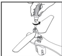
1. С помощью отвертки выкрутите фиксирующие винты, затем снимите пропеллеры.
