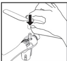
2. Установите пропеллеры с меткой «А» на моторы с меткой «А», а пропеллеры с меткой «В» на моторы с меткой «В», затем закрутите фиксирующие винты.
