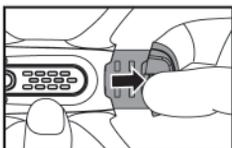
2. Нажмите на крышку аккумулятора и вытащите его из дрона.
