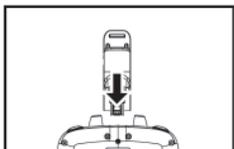
1. Вставьте кронштейн для крепления мобильного телефона в гнездо, расположенное в верхней части пульта управления.
