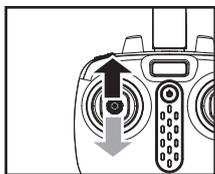
с. Переместите левую ручку пульта управления до упора вверх, а затем до упора вниз. Когда прозвучит длинный звуковой сигнал, это значит, что связь пульта с дроном установлена и определение носовой части в режиме «Headless» завершено.
