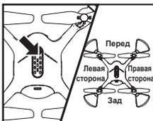
б. Включите питание дрона, нажав и удерживая 1-2 секунды кнопку выключения/включения питания на верхней части корпуса дрона. Затем установите квадрокоптер на ровную поверхность, точно расположив его хвостовой частью к пульта.
