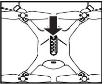
Шаг 2: включите питание дрона, нажав и удерживая 1-2 секунды кнопку включения/выключения питания, расположенную сверху корпуса дрона.
