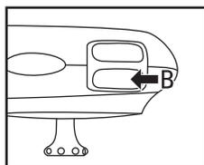
Способ 3: когда дрон находится в полете, нажмите на пульте кнопку «В», квадрокоптер медленно приземлится и моторы автоматически выключатся.
