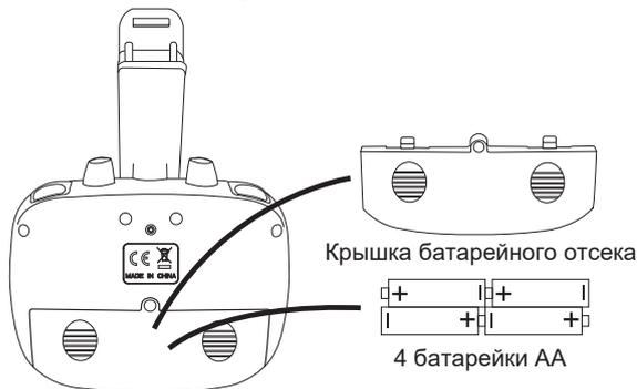
Установка батареек: откройте крышку батарейного отсека на задней панели пульта. Строго соблюдая полярность, в соответствии с метками полярности в батарейном отсеке, установите 4 батарейки AA (не входят в комплект) и закройте крышку батарейного отсека пульта управления.
