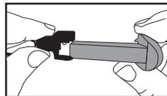
3. Строго соблюдая полярность, подключите соответствующий разъем USB кабеля для зарядки к разъему аккумулятора.
