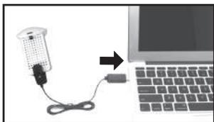
Вставьте соответствующий разъем USB кабеля для зарядки с подключенным аккумулятором в USB порт компьютера. (Во время зарядки будет светиться индикатор. Когда индикатор погаснет, это значит, что аккумулятор полностью заряжен). Время зарядки не более 130 минут.
