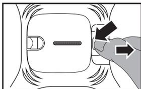
2. Нажмите на фиксатор в нижней части аккумулятора и извлеките аккумулятор из дрона.
