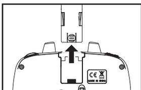
1. Потянув вверх, снимите с пульта управления крышку отсека для установки кронштейна.
