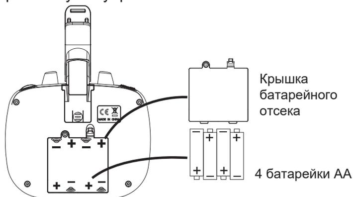
Установка батареек: откройте крышку батарейного отсека на задней панели пульта. Строго соблюдая полярность, в соответствии с метками полярности в батарейном отсеке, установите 4 батарейки AA (не входят в комплект) и закройте крышку батарейного отсека пульта управления.
