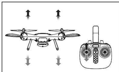
При перемещении левой ручки пульта (Газ/Курс) вверх дрон набирает высоту. При перемещении этой ручки вниз дрон снижается.
