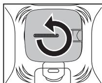
2. Установите камеру в посадочное гнездо на корпусе дрона и поверните камеру против часовой стрелки до упора.
