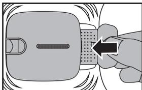
4. После зарядки вставьте аккумулятор в аккумуляторный отсек квадрокоптера.
