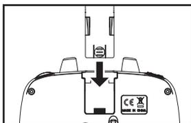
2. Вставьте кронштейн для крепления смартфона в отсек, расположенный в верхней части пульта управления.
