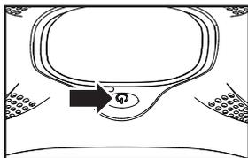
1. Выключите питание дрона, нажав кнопку включения/выключения питания на верхней части корпуса дрона.
