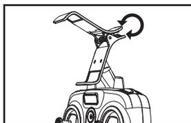
3. Чтобы установить смартфон, нажмите на клавиши клипсы кронштейна, установите смартфон и отпустите клавиши клипсы.
