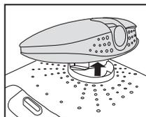
2. Снимите камеру вверх и отсоедините ее провод от разъема дрона.
