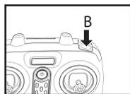
Способ 3: установите дрон на ровную горизонтальную поверхность и нажмите кнопку «В». Дрон взлетит в автоматическом режиме и зависнет на заданной высоте.
