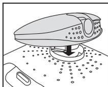
1. Вставьте разъем провода камеры в разъем на корпусе дрона.
