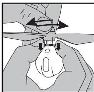
Нажмите фиксацию пропеллера вниз, а затем, чтобы снять пропеллер с меткой "А", вращайте его по часовой стрелке, чтобы установить на вал пропеллер с меткой "А", вращайте его против часовой стрелки. Чтобы снять пропеллер с меткой "В", вращайте его против часовой стрелки, чтобы установить пропеллер с меткой "В", вращайте его по часовой стрелке.
