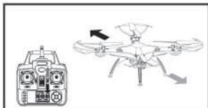
Если при нейтральном положении ручек пульта дрон постоянно дрейфует вперед или назад, устранили этот дрейф, используя триммер тангажа. Устранили дрейф вперед, перемещая триммер тангажа вниз, а дрейф назад, перемещая триммер тангажа вверх.
