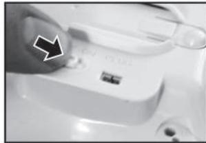
3. Вставьте аккумулятор в отсек и закройте крышку. Включите питание дрона, переместив его выключатель питания в положение «ON».
