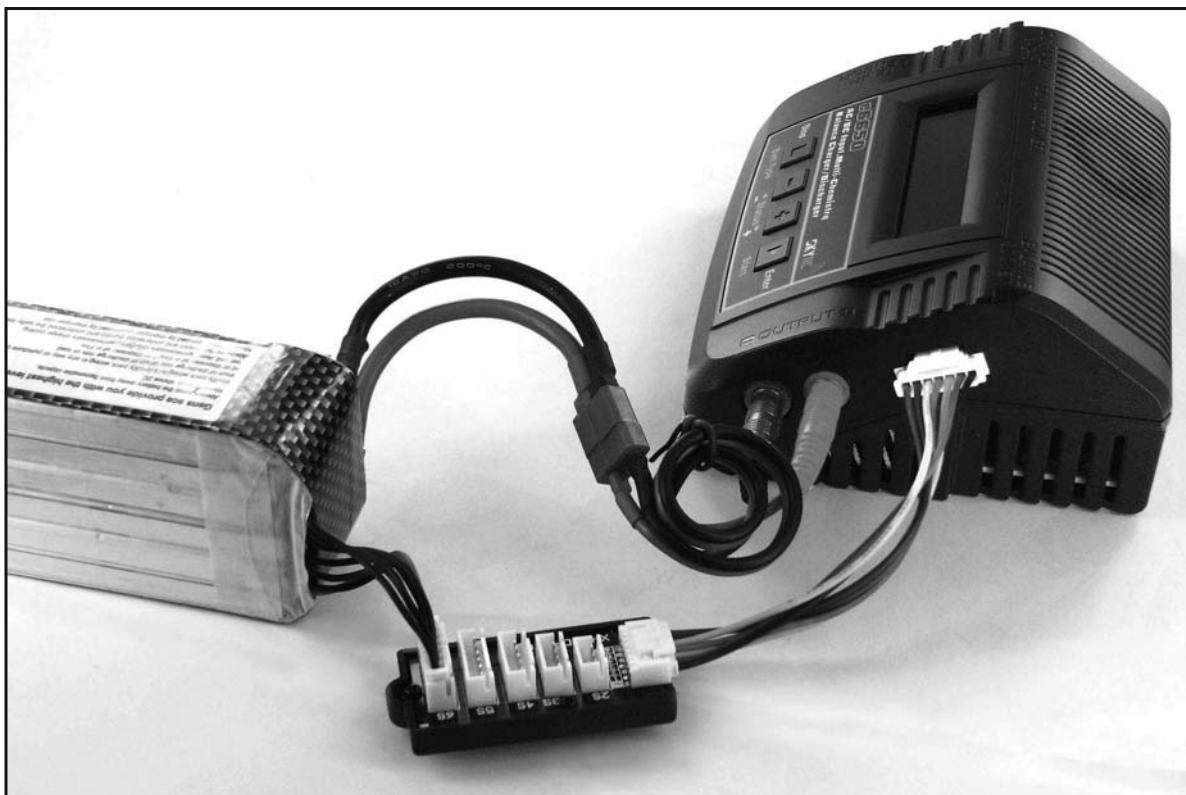
Перед началом зарядки провода подключения аккумулятора, а также провод балансировки должны быть подключены в соответствии с приведенной схемой
