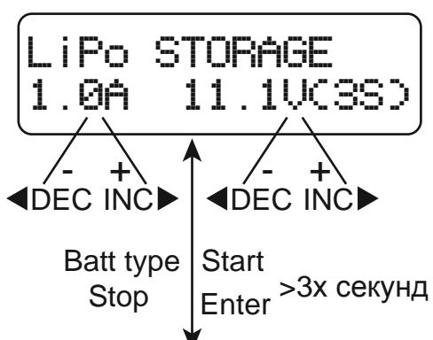
На данном экране устанавливается ток и напряжение аккумулятора. Зарядка и разрядка приведут к уровню напряжения, соответствующему режиму хранения..
