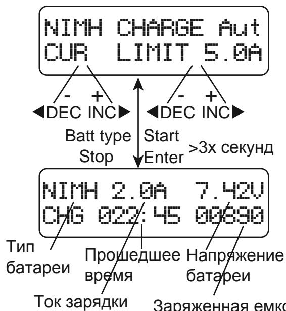
На данном экране показана программа для зарядки NiCd/NiMH аккумуляторов, предназначенных для использования в радиоуправляемых моделях. Нажмите кнопку START/ENTER, чтобы параметр замигал, а затем - INC или DEC, чтобы изменить его значение. Повторно нажмите кнопку START/ENTER, чтобы сохранить значение.
