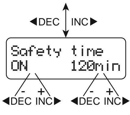
Одновременно с началом процесса зарядки происходит запуск встроенного таймера безопасности. В случае обнаружения ошибки, или же если система безопасности не может определить заряд аккумулятора, данная функция позволяет избежать перезарядки. Рекомендации по вычислению корректного времени таймера приводятся ниже.
