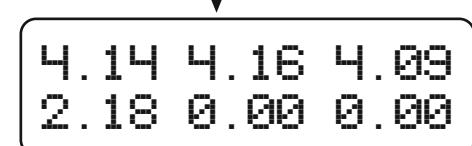
Четвертая банка повреждена. В случае разрыва цепи напряжение будет равно нулю.
