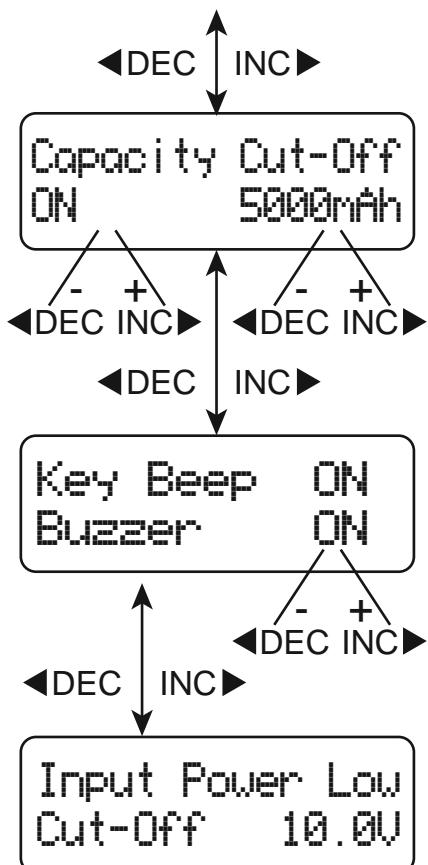
Данная программа служит для максимальной защиты емкости аккумулятора. Если напряжение дельта-пика не может быть определено, либо же происходит срабатывание таймера безопасности, процесс зарядки автоматически останавливается при достижении аккумулятором установленного пользователем максимального значения емкости.
