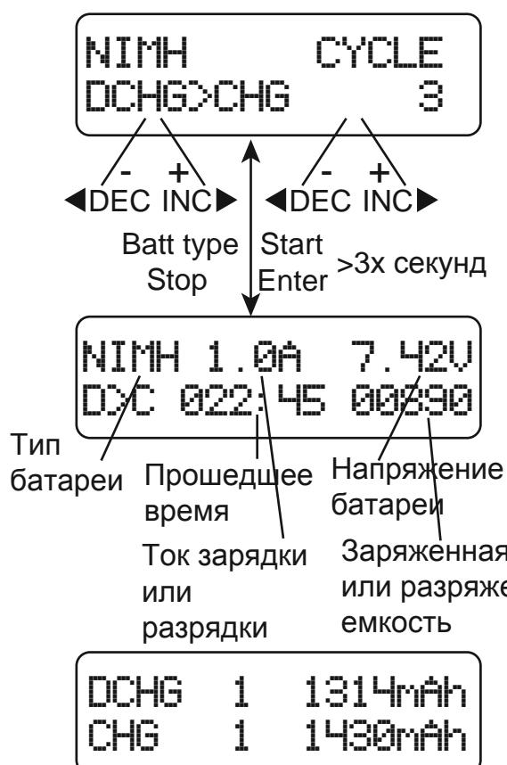
В левой части устанавливается последовательность процессов, в правой - количество циклов. Возможно установить от 1 до 5 циклов.
