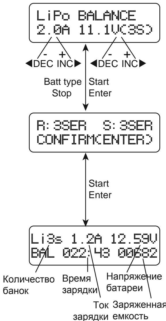
В левой стороне первой строки показан тип выбранного аккумулятора. Значение в левой стороне второй строки на экране соответствует току зарядки. Для начала процесса после установки значений тока и напряжения удерживайте кнопку START/ENTER более 3 секунд.
