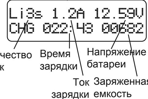
На данном экране в реальном времени показывается статус зарядки аккумулятора. Чтобы прервать процесс зарядки, однократно нажмите кнопку BATT TYPE/STOP.
