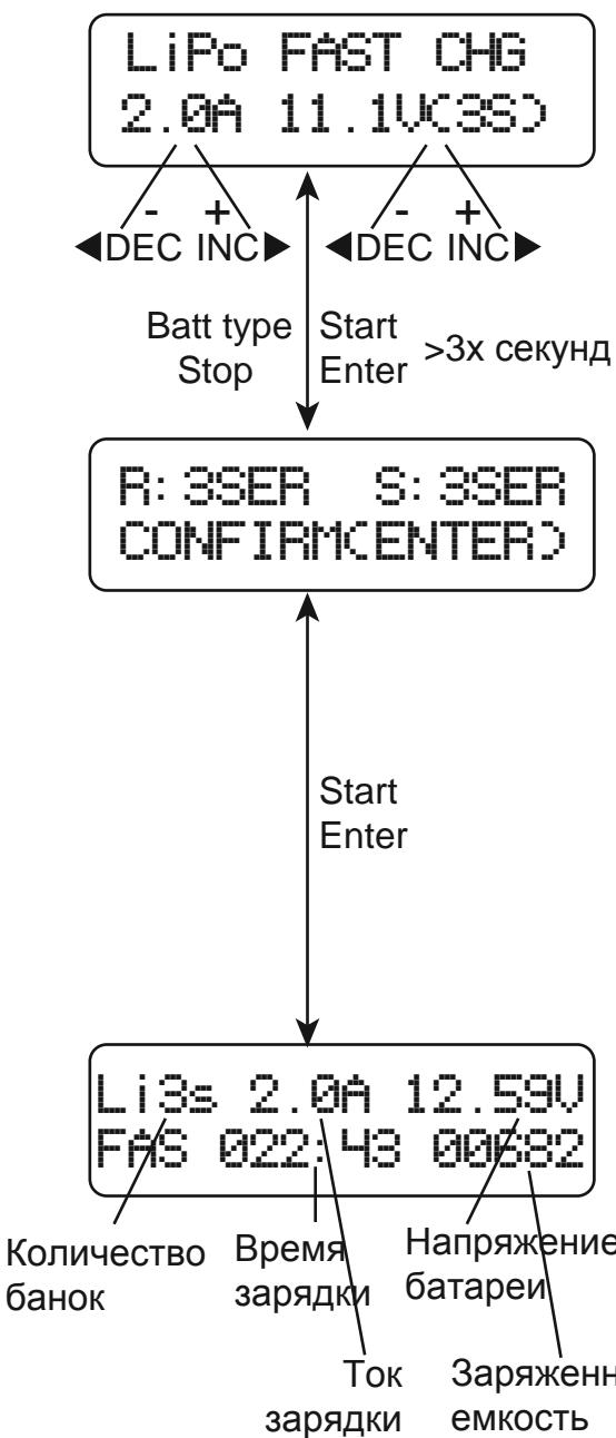
Значение в левой стороне второй строки на экране соответствует току зарядки. В левой стороне второй строки задается напряжение аккумулятора. Чтобы начать процесс зарядки после установки значений тока и напряжения, удерживайте кнопку STAR/ENTER более 3х секунд.
