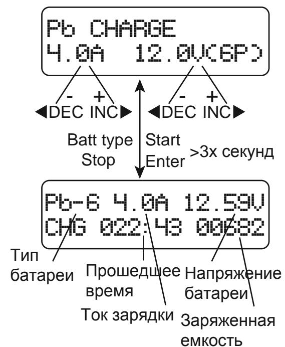
В левой части устанавливается ток зарядки, в правой - номинальное напряжение. Допустимый интервал тока - 0,1-5,0А, напряжение должно подходить для заряжаемого аккумулятора. Чтобы начать процесс зарядки, удерживайте кнопку START/ENTER более 3х секунд.
