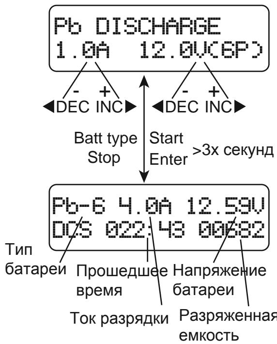
В левой части устанавливается ток разрядки, в правой - номинальное напряжение. Допустимый интервал тока - 0,1-5,0А, напряжение должно подходить для заряжаемого аккумулятора. Чтобы начать процесс зарядки, удерживайте кнопку START/ENTER более 3х секунд.
