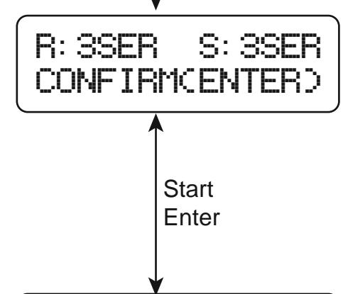
На данном экране показано число банок, установленное пользователем и определенное процессором. "R" - количество банок, определенное зарядным устройством, "S" - выбранное пользователем в предыдущем пункте меню. Если значения совпадают, Вы можете нажать кнопку START/ENTER и начать процесс зарядки. Если же нет - следует нажать кнопку BATT TYPE/STOP, чтобы вернуться к предыдущему пункту и еще раз проверить количество банок.
