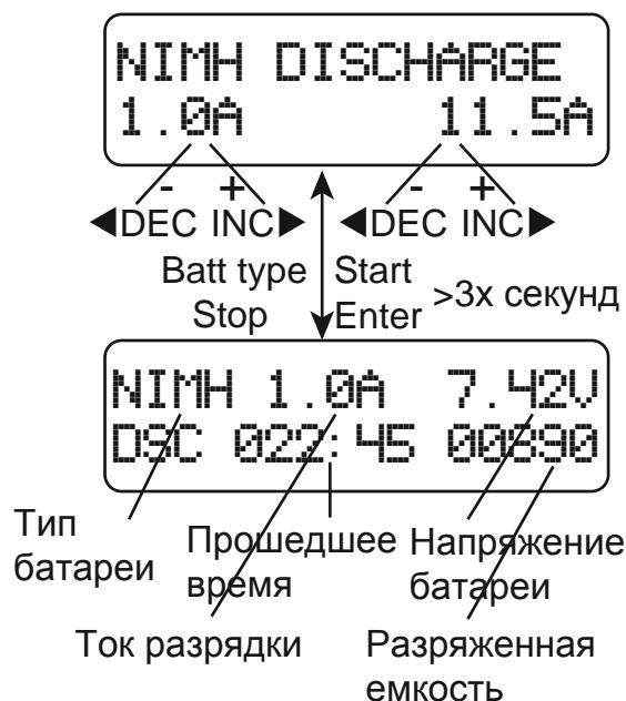
Установите ток зарядки слева и конечное напряжение справа. Ток зарядки может изменяться в пределах 0,1-1,0А, конечное напряжение - от 0,1 до 25,0В. Для начала разрядки удерживайте кнопку START/ENTER более 3x секунд.
