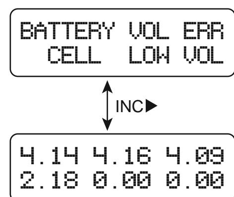
Напряжение на одной из банок ниже допустимого.
