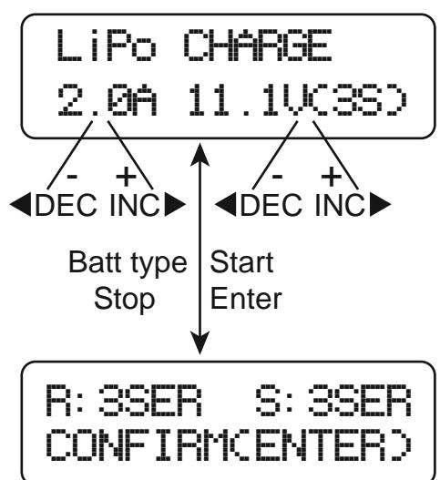
В левой стороне первой строки показан тип выбранного аккумулятора. Значение тока в левой стороне второй строки на экране изменяется пользователем. Для начала процесса удерживайте кнопку START/ENTER более 3 секунд после установки значений тока и напряжения.
