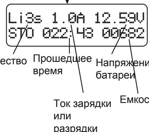
На данном экране в реальном времени показывается статус зарядки аккумулятора. Чтобы прервать процесс зарядки, один раз нажмите кнопку BATT TYPE/STOP.
