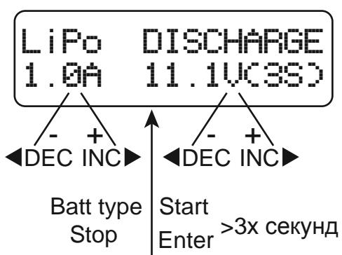
Чтобы избежать глубокой разрядки, значение тока разрядки слева не должно превышать 1C, а значение напряжение справа не должно быть ниже напряжения, рекомендованного производителем. Чтобы начать процесс разрядки, удерживайте кнопку START/ENTER более 3x секунд.
